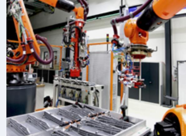
*Demontagezelle***Batteriesysteme automatisiert demontieren und zerlegen****Open Hybrid LabFactory e.V.**
