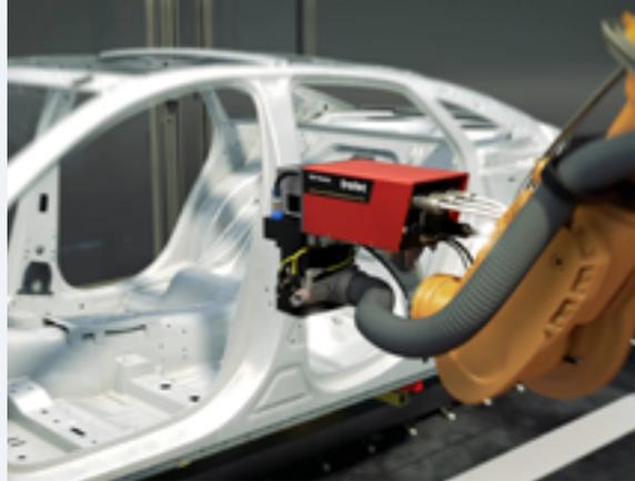
Trotec VIN Marker für die Kennzeichnung von Fahrzeug-Identifikationsnummern
