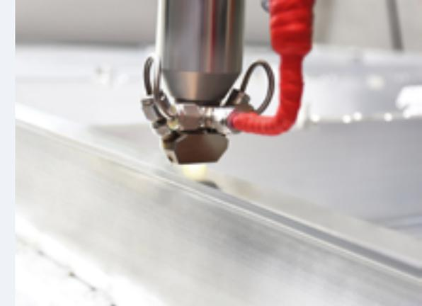
*Plasmabeschichtung eines Batteriegehäuses*
