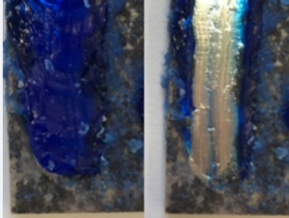
*Schutz vor korrosiver Unterwanderung - nach 6 Wochen PV1209 im offenen Bauteil, links vor und rechts nach Entfernen des dauerplastischen Dichtstoffs*
