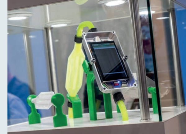
Aluminiumgehäuse zur Kühlung von Leistungselektroniken
